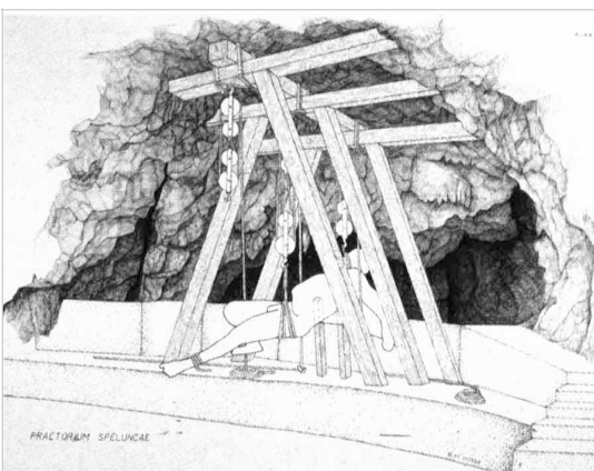
Fig. 10: Disegno ricostruttivo della machina tractoria utilizzata per la messa in opera del gruppo dell'Accecamento di Polifemo a Sperlonga (disegno: Odysseus. Mythos und Erinnerung , a cura di B. Andreae, Mainz, P. von Zabern 1999, p. 199)
